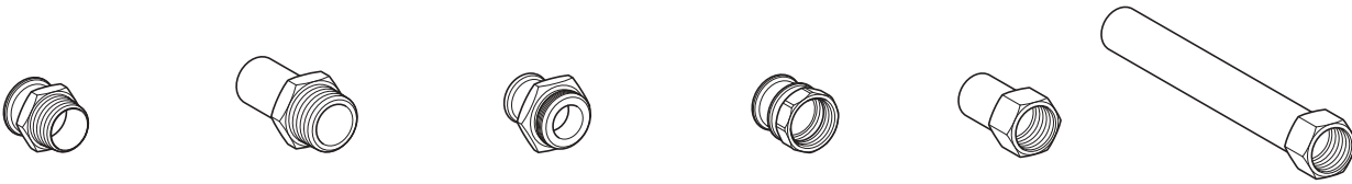
Kuva 9: Geberit Mapress Ruostumaton Teräs -liitinmuhvit ulkokierteellä ja liitinmuhvit sisäkierteellä
