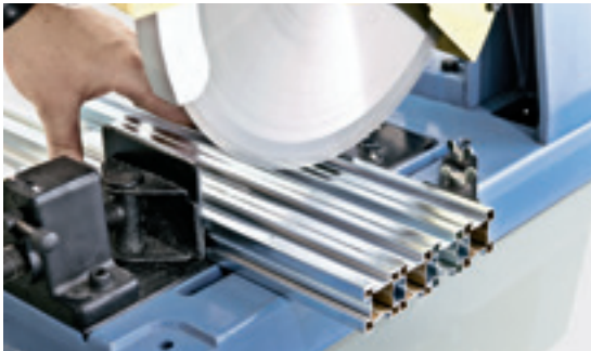
↑ Katkaisusahalla voidaan lyhentää samanaikaisesti enintään neljä Geberit GIS -profiilia.
