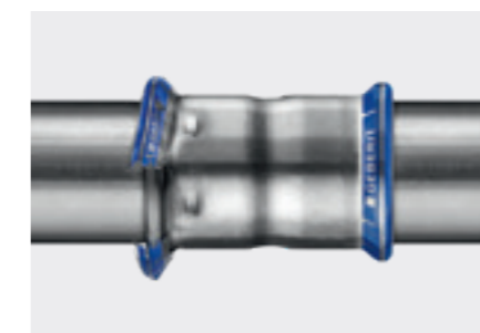
Värilliset puristusindikaattorit tekevät puristamattomat Mapress-liittimet helposti huomattaviksi jo ennen tiiveyskoetta.
