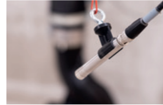
Geberit Silent-db20 Sovent -yhteen ilmaäänien huoneakustinen mittausta.
